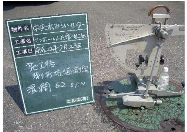
湿潤時 施工後 マンホール蓋・B.P.N 62
