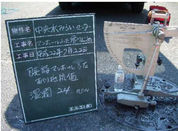
湿潤時 既設 マンホール蓋・B.P.N 24
