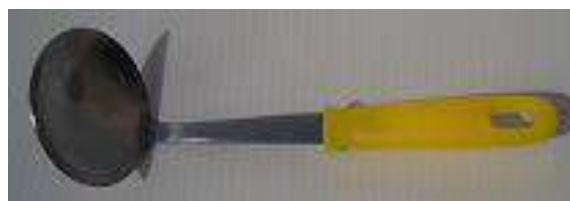
⑦主剤をすくうレードル
